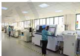
自动插件 Automatic Insertion
